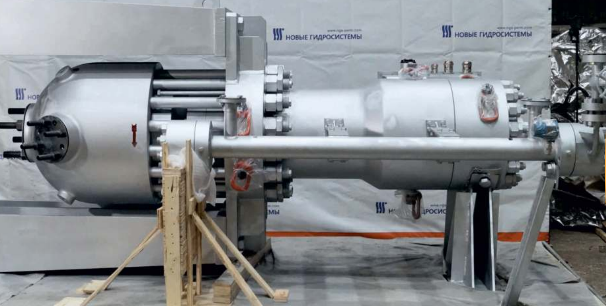
Герметичный циркуляционный насос высокого давления для первого контура в г.Курчатов
