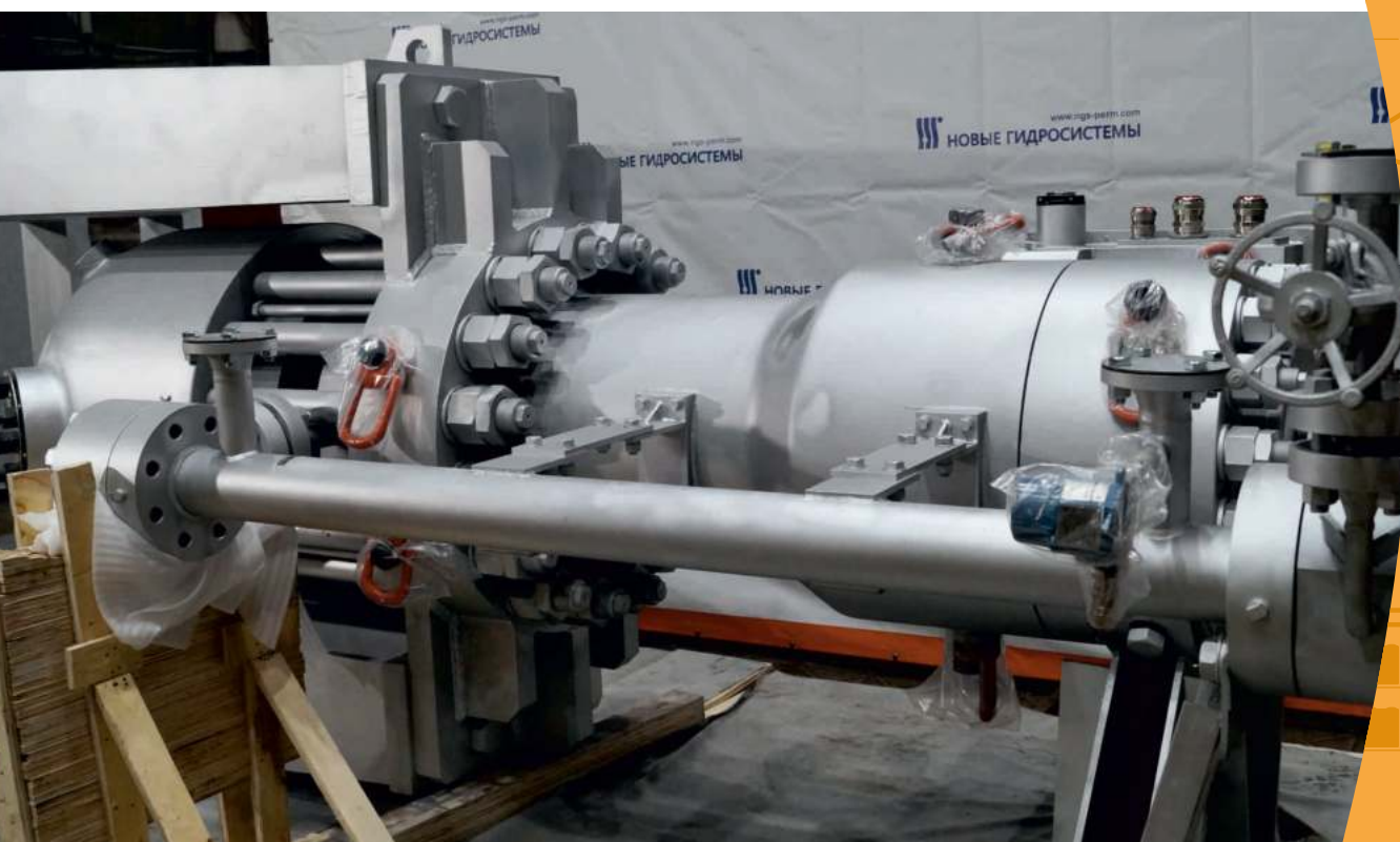
Герметичный циркуляционный насос высокого давления для первого контура в г.Курчатов
